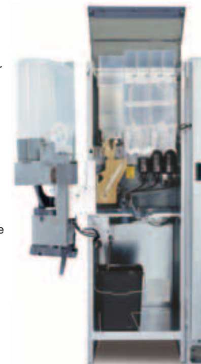
Ausgezeichnete innere Zugangsmöglichkeit. Bei offener oberer Abdeckplatte kann die Tür nicht geschlossen werden.
